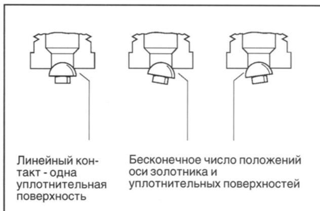
Рис. 2 Клапан конденсатоотводчика с опрокинутым поплавком при износе
