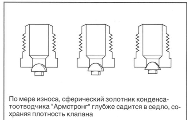
**Рис. 1.** Конструкция конденсатоотводчика с опрокинутым поплавком "Армстронг"
