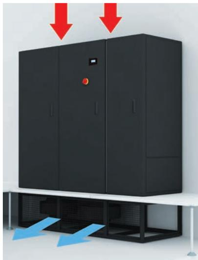
Стандартная модель для монтажа по периметру помещения. Высота свободного пространства под фальшполом должна составлять как минимум 550 мм.
