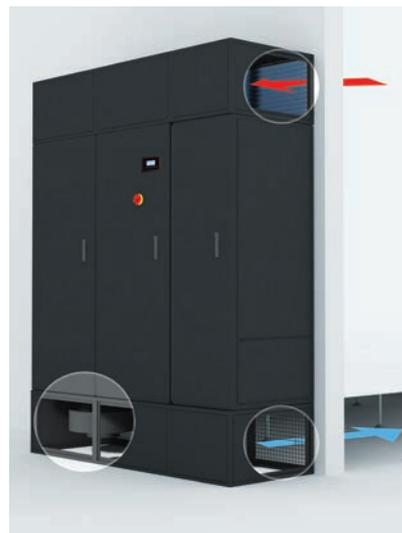
Модель для монтажа за пределами помещения без фальшпола и приточного воздуховода с обратной стороны. В данном случае основание с фиксированной высотой 550 мм оснащается боковыми панелями и задними воздухораспределительными решетками. При отсутствии системы воздуховодов, можно установить воздухораспределительную камеру с задней воздухозаборной системой.
