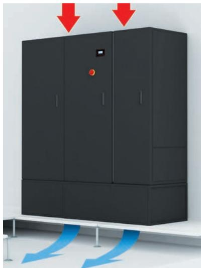
Стандартная модель для монтажа по периметру помещения при высоте свободного пространства под фальшполом менее 550 мм. В данном случае основание с фиксированной высотой 550 мм и боковыми панелями устанавливается над полом. При этом следует убедиться, что между кондиционером и потолком достаточно свободного пространства для надлежащего забора воздуха.
